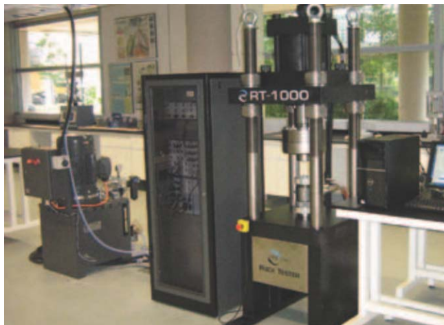
Установка для испытания горных пород IPC Global модели RT-1000 с жесткой рамой, имеющей четыре колонны и удобным механизмом регулирования положения траверсы, обеспечивает установку разнообразных приспособлений, применяемых в новейших методах исследований.
