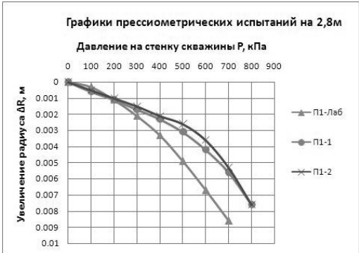
Рис. 12. Графики pressiометрических испытаний элювиального суглинка на глубине 2,8 м (П1-Лаб – вычисленный график)
