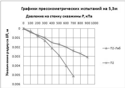
Рис. 13. Графики pressiометрических испытаний элювиального суглинка на глубине 5,3 м (П2-Лаб – вычисленный график)
