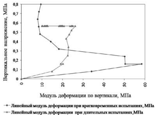
Рис. 7. График зависимости изменения линейного модуля деформации от величины вертикальных напряжений
