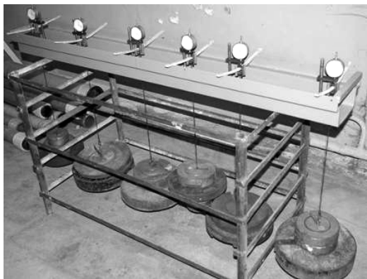
Рис.10. Установка для проведения длительных испытаний на статический трехточечный изгиб
