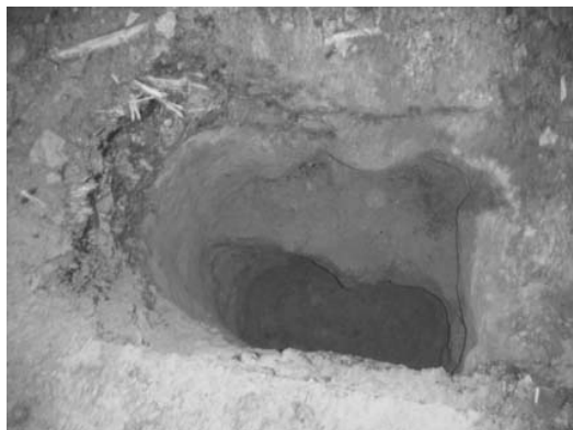
Рис.15 Фото шурфа вскрытого без крепления
