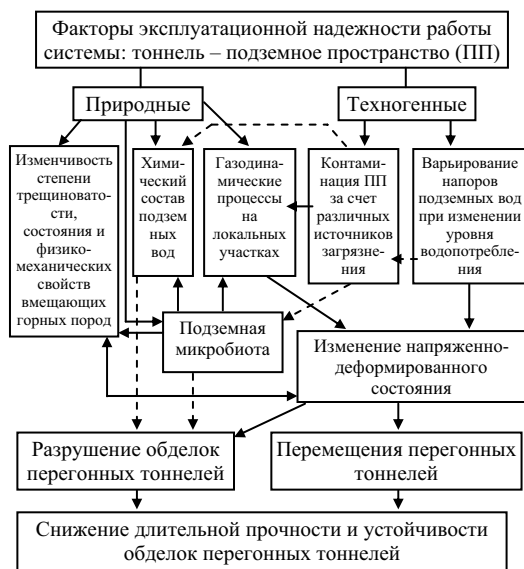
Рис. 1. Схематизация воздействия природных и техногенных факторов на эксплуатационную надежность работы системы: тоннель – подземное пространство
