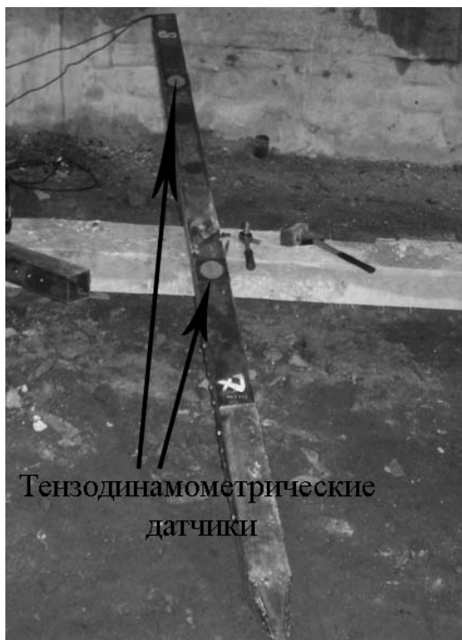
Рис. 10 Вид 1-ой секции тензодинамометрического зонда перед погружением
