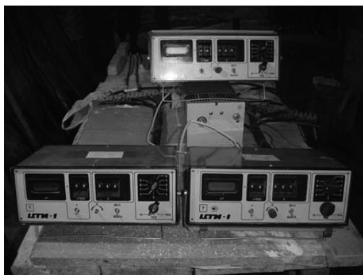
Рис. 12 Оборудование для регистрации показаний тензодатчиков (ЦТИ)
