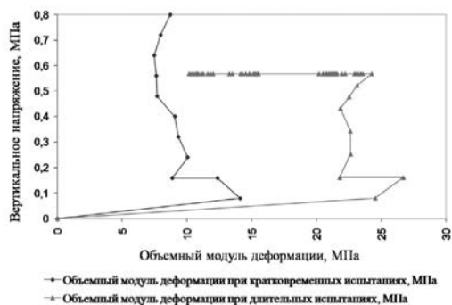
Рис. 8. График зависимости изменения объемного модуля деформации от величины вертикальных напряжений
