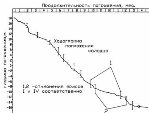
Рис.4 Мониторинг при строительстве крупногабаритного опускного колодца КНС г.Санкт-Петербурга
