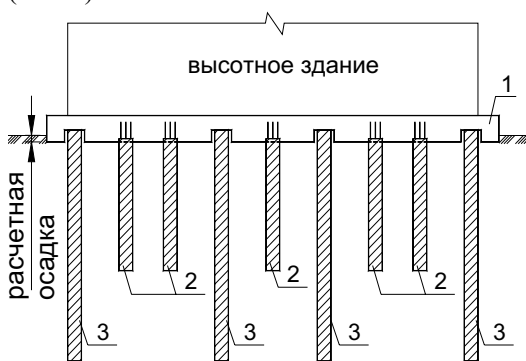
Рис. 2. Конечный этап развития деформаций – вовлечение длинных свай в работу свайно-плитного фундамента
