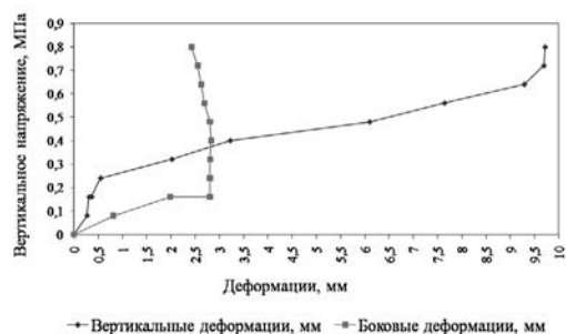
Рис. 4. График зависимости изменения линейных деформаций от роста величины вертикальных напряжений при кратковременных трехосных испытаниях
