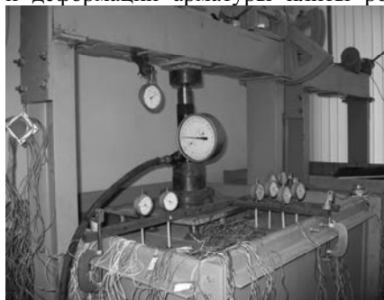
Рис. 1. Общий вид испытаний моделей плитно-свайных фундаментов.
