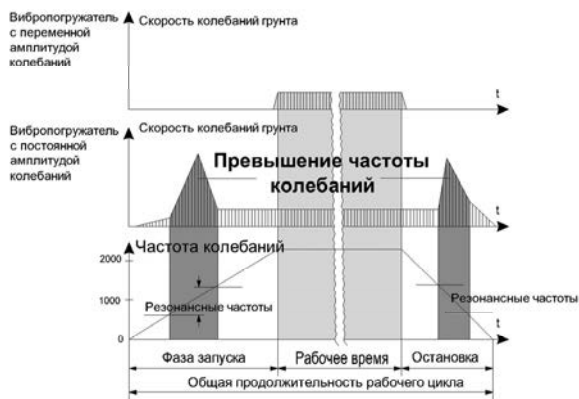
Рис.4. График сопоставления режимов работы вибропогружателей с постоянной и переменной амплитудой колебаний.
