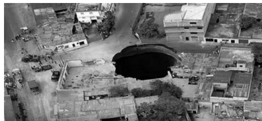
Рис. 2. Провал диаметром около 30 м и глубиной 100 м в 2007 г. в Гватемале, захвативший несколько домов.
