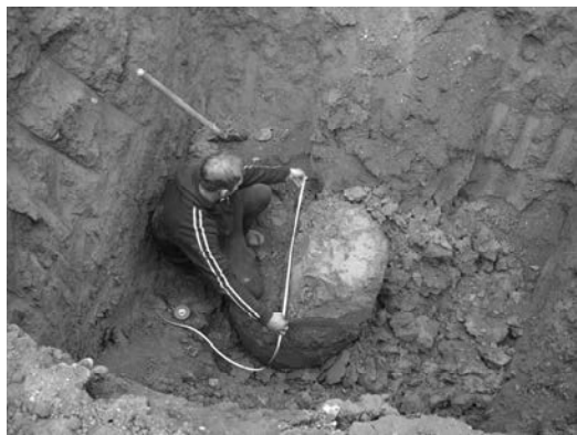
Рис.1. Буронабивная свая в пылеватом обводненном песке, изготовленная шнеком D=180 мм
