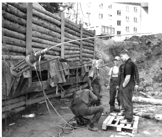
Рис.17. Испытание фиберглассового анкера в г. Екатеринбург
